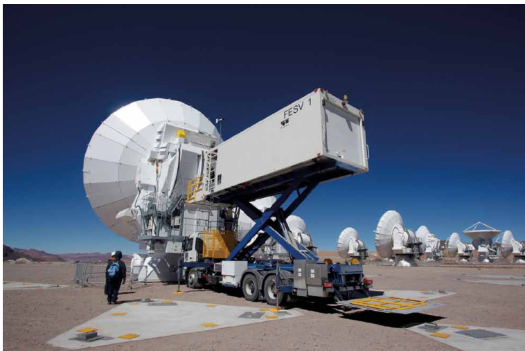
執勤中的「前段維護特種車」，這由台灣團隊主導製造的特種車可以增進陣列運作的效能並減低運轉的碳排量
